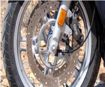
Figura 10.1: Imagen de un freno ABS, capaz de detener el movimiento de un vehículo
