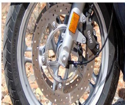
Figura 10.1: Imagen de un freno ABS, capaz de detener el movimiento de un vehículo
